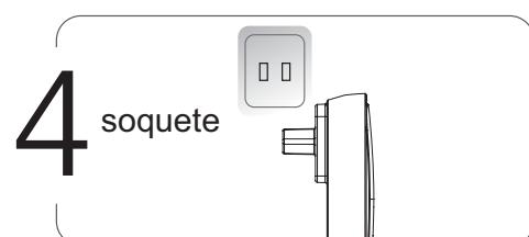
O receptor deve ser conectado diretamente na rede elétrica 110/220volts.
