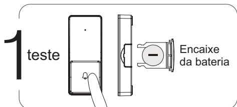
Abra a embalagem e remova a fita que faz a proteção da bateria, logo em seguida feche o compartimento da bateria.
