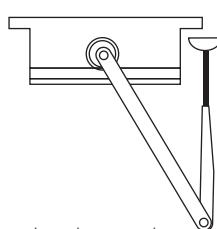
3 - Faça a fixação do antebraço da mola com seu parafuso de fixação e coloque a tampa do eixo na parte inferior.
