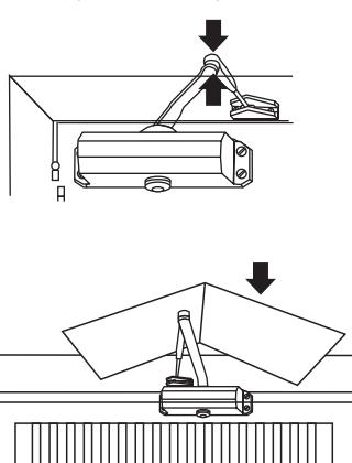
2 - O braço da mola (com suporte) deve ser montado a 90°. Para desmontá-lo do antebraço, pressione entre as duas partes com uma chave de fenda.
